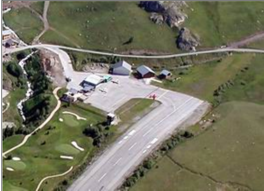
L'altiport H. Giraud à l'Alpe d'Huez. Un prolongement d'arrêt donne un « droit à l'erreur »
