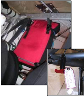
Installation du parachute derrière les sièges et poignée de déclenchement avec sa goupille
