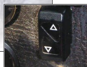
Pompe électrique assurant la manœuvre des skis actionnée par un simple contacteur haut/bas
