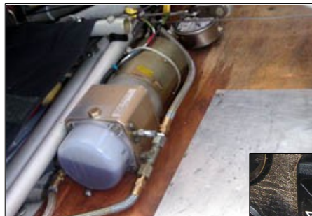
Pompe électrique assurant la manœuvre des skis actionnée par un simple contacteur haut/bas
