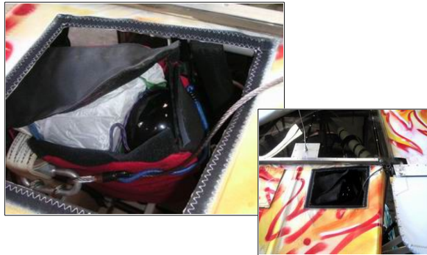
Sac du parachute vu par dessus : on aperçoit la toile et le haut de la fusée. Une trappe de toile sur le fuselage fixée par des velcro de sécurité est ouverte par la fusée.
