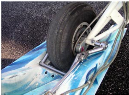
Skis relevés pour l'atterrissage sur roues.
