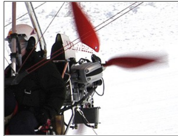
BMW 1100 cc injection sur pendulaire Take-Off distribué par ULM EVASION, Claude Delluc à Romans. moteur très silencieux ne consommant que 7 l/h
