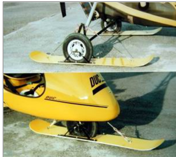
Skis fixes avec une échancrure, les roues dépassent sous les skis
