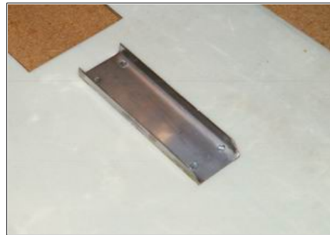
Arête de stabilisation sous les skis
