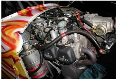
Rotax 912 – 80cv, (912-S et 914 : 100cv) 4 temps, double allumage, refroidissement air et eau, carter d'huile séparé, à gauche sur la photo
