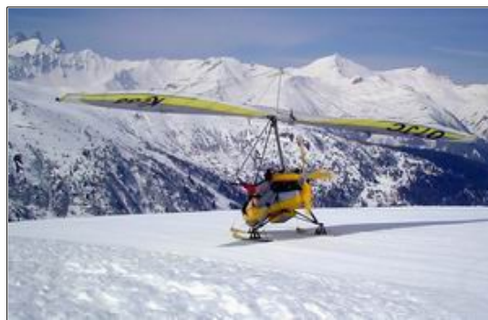
Pendulaire, le poids du moteur est à l'arrière. (photo Ph. Clément)
