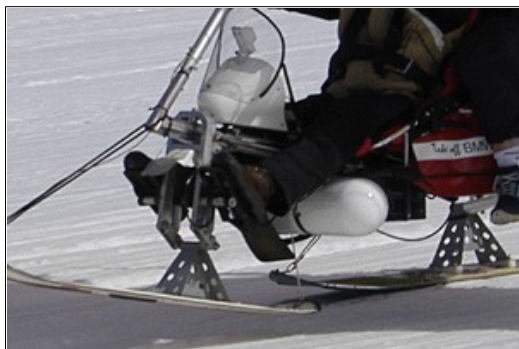
Container du parachute sous un chariot de pendulaire (photo Ph. Clement).
